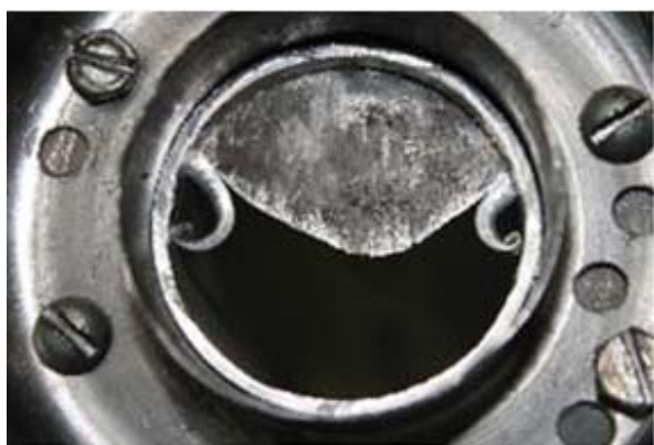
Рис. 1. Промежуточное положение ножа при отрезке трубы
