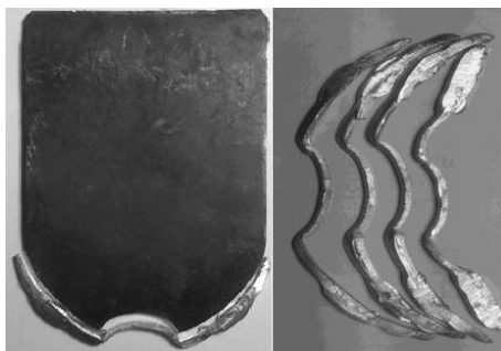
Рис. 11. Стружка-отход при резке трубы ножом с выемкой
