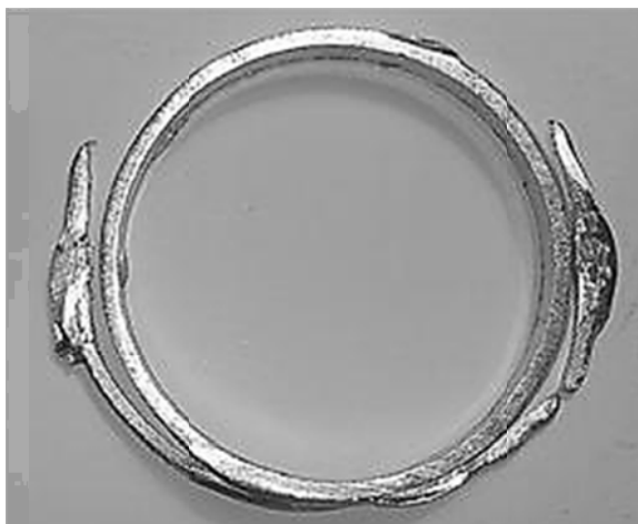
Рис. 6. Соединение внутренней стружки с наружной
