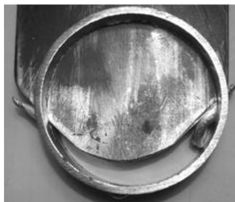
Рис. 2. Отделение стружки-отхода при промежуточном положении ножа
